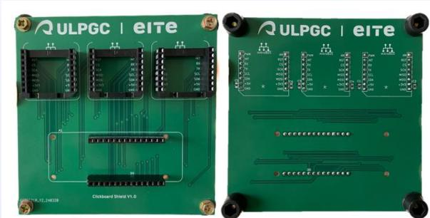
Figura III. PCB ULPGC/EITE Click Shield.
